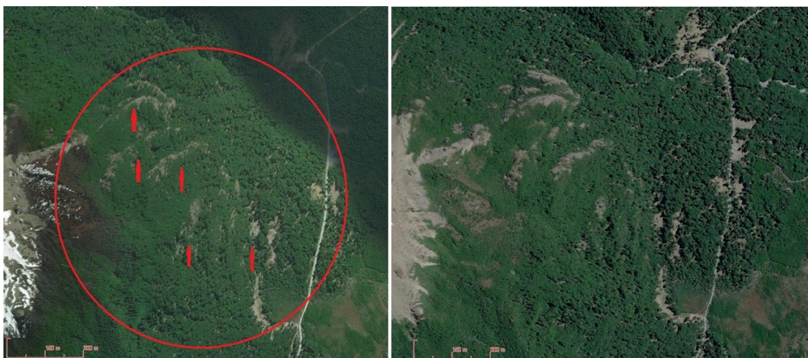
Figura 23: Imagen satelital en distintas fechas de toma. Grietas de desplazamiento (flechas rojas) modificando el bosque.
