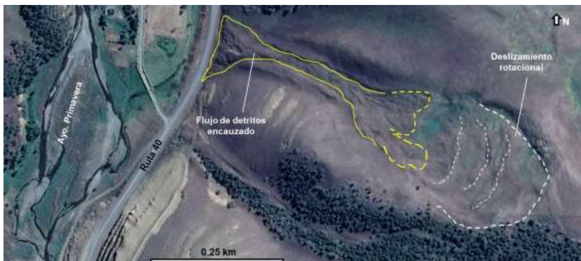
Imagen N° 17. Detalle de imagen satelital donde se observa un flujo de detritos que posee su zona de arranque de material previamente deslizado rotacionalmente.
