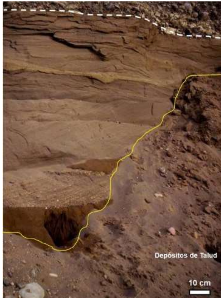
Imagen Nº 7. Fotografía de detalle donde se observa el contacto de la base de los conglomerados observados en la imagen 6 con los bancos arenosos con estratificación paralela y entrecruzada tabular planar y en artesa
