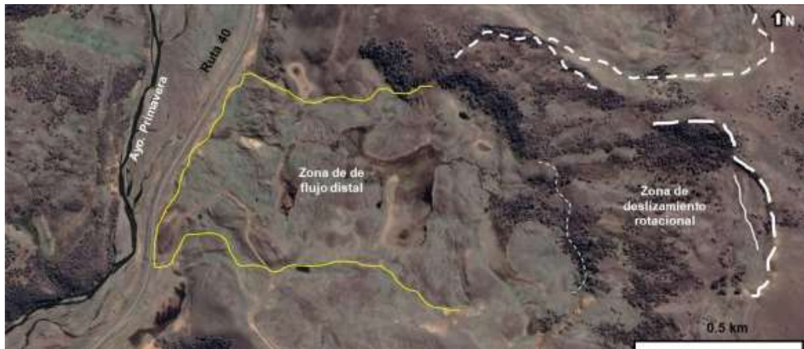
Imagen N° 16. Detalle de imagen satelital donde se observa un movimiento compuesto en donde en la parte apical se desarrolla un deslizamiento rotacional que pierde cohesión aguas abajo transformándose en un flujo de detritos
